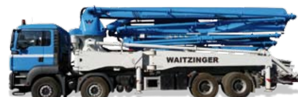
42 M5 ST (XXH) 37,6 m Vízsintes hatósugár / Horizontale Reichweite 41,6 m Merőleges hatósugár / Vertikale Reichweite
