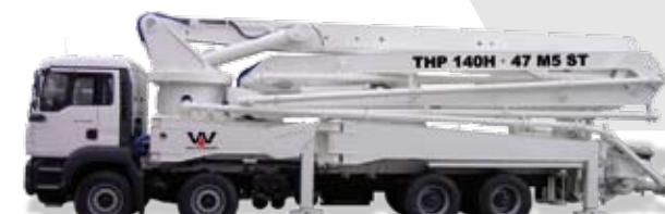
47 M5 ST 41,9 m Vízsintes hatósugár / Horizontale Reichweite 46,6 m Merőleges hatósugár / Vertikale Reichweite
