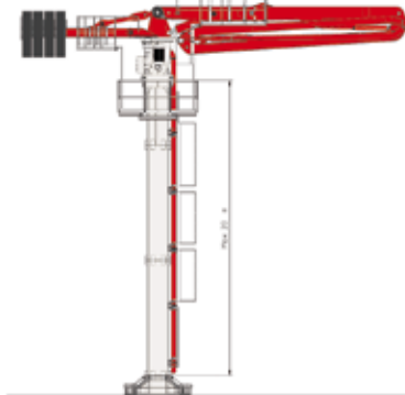
KM 33 R4 32,6 m Vízszintes/Merőleges hatósugár Horizontale/Vertikale Reichweite 28,8 m Mélységi hatósugár Reichtiefe
