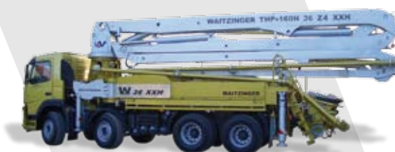
36 Z4 XXH 31,5 m Vízsintes hatósugár / Horizontale Reichweite 35,5 m Merőleges hatósugár / Vertikale Reichweite
