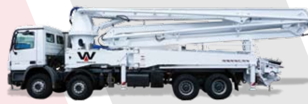
42 R4 ST (XXH) 38,0 m Vízsintes hatósugár / Horizontale Reichweite 42,0 m Merőleges hatósugár / Vertikale Reichweite
