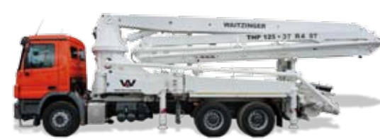
37 R4 ST 32,9 m Vízsintes hatósugár / Horizontale Reichweite 36,6 m Merőleges hatósugár / Vertikale Reichweite
