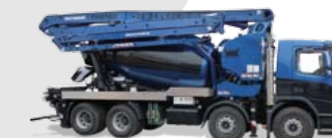
29 Z4 XXH 24,1 m Vízsintes hatósugár / Horizontale Reichweite 28,1 m Merőleges hatósugár / Vertikale Reichweite
