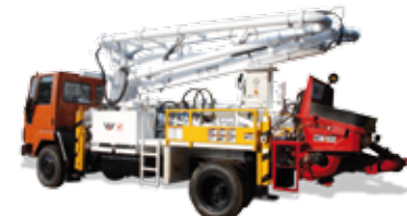
17 R3 XT 13,1 m Vízsintes hatósugár / Horizontale Reichweite 16,1 m Merőleges hatósugár / Vertikale Reichweite
