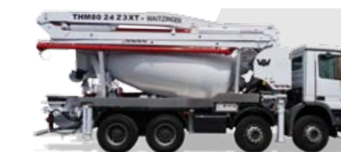
24 Z3 XT 20,0 m Vízsintes hatósugár / Horizontale Reichweite 24,0 m Merőleges hatósugár / Vertikale Reichweite
