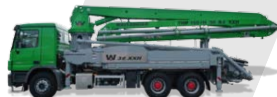
36 R4 XXH 32,1 m Vízsintes hatósugár / Horizontale Reichweite 36,1 m Merőleges hatósugár / Vertikale Reichweite
