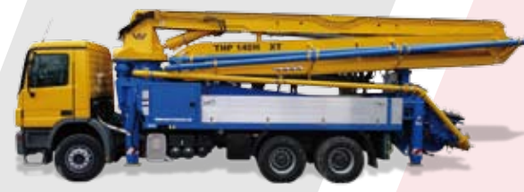
39 R4 XT 34,6 m Vízsintes hatósugár / Horizontale Reichweite 38,6 m Merőleges hatósugár / Vertikale Reichweite
