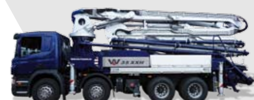
35 Z5 XXH 30,1 m Vízsintes hatósugár / Horizontale Reichweite 34,1 m Merőleges hatósugár / Vertikale Reichweite
