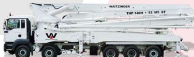
52 M5 ST 47,5 m Vízsintes hatósugár / Horizontale Reichweite 51,5 m Merőleges hatósugár / Vertikale Reichweite
