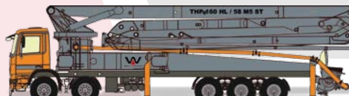
58 M5 ST 52,2 m Vízsintes hatósugár / Horizontale Reichweite 57,2 m Merőleges hatósugár / Vertikale Reichweite
