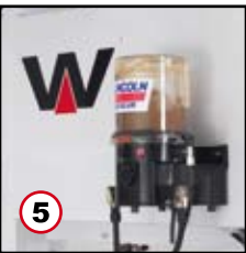
5 Automata központi zsírozó, kézzel is zsírozható progresszív elosztóval Automatische Schmieranlage mit manuell abschmierbarem Progressivverteiler
