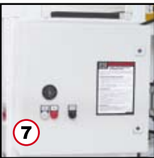
6 Elektro-hidraulikus követővezérlés Schaltschrank mit Diagnosemodul und Notsteuerung
