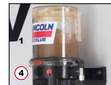
4. Automata központi zsírozó, kézzel is zsírozható progresszív elosztóval Automatische Schmieranlage mit manuell abschmierbarem Progressivverteiler
